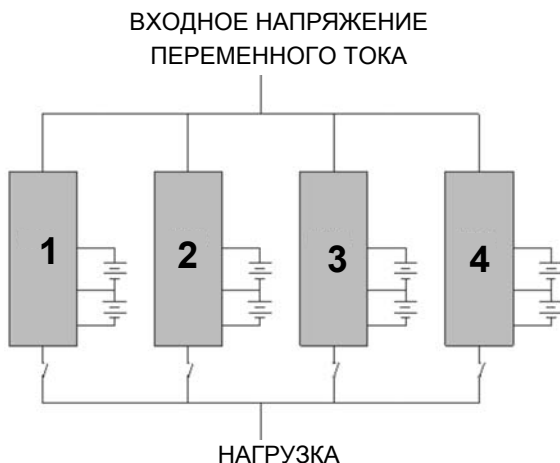
Рисунок 25 — Схема подключения изделий в систему параллельного резервирования.
